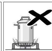
Utilizați recipiente de dimensiune potrivită cu fiecare arzător. Nu utilizați recipiente mici pe arzătoare mari. Flacăra nu trebuie să atingă lateralele recipientului.
