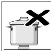
Stawiać naczynia na rusztach, w żadnym wypadku nie stawiać ich bezpośrednio na palniku. Przed użyciem palników sprawdzić, czy ruszty i nakładki palników są prawidłowo założone.
