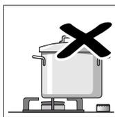
Umieszczać naczynie na palniku w położeniu dokładnie centrycznym. W przeciwnym razie może się ono wyrzucić.
