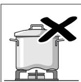
Nie należy używać odkształconych naczyń, które stoją w sposób niestabilny na płycie kuchenki i mogą się przewrócić. Należy stosować wyłącznie naczynia o płaskim i grubym dnie.
