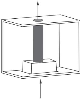
1. Подвесной шкафчик, в который будет устанавливаться вытяжка, должен быть предварительно подготовлен. В дне шкафчика, в соответствии с размерами вытяжки, необходимо вырезать прямоугольное отверстие (см. Рис. 11). Кроме того, в потолке шкаф-
