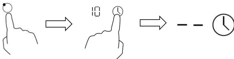
5. После установки заданного времени обратный отсчёт начинается немедленно. На дисплее отображается оставшееся время, а индикатор таймера мигает в течение 5 секунд.
