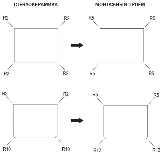
**РАЗМЕРЫ МОНТАЖНОГО ПРОЕМА ПРИ МОНТАЖЕ ВРОВЕЬ СО СТОЛЕШНИЦЕЙ**
