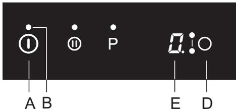
Включите варочную панель сенсором ВКЛ./ВЫКЛ. (A). На дисплеях конфорок на 10 секунд загорятся «0».
