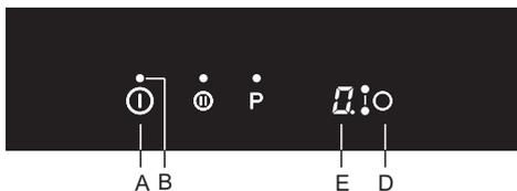
Чтобы выключить варочную панель, нажмите на сенсор ВКЛ./Выкл. (А). Раздастся звуковой сигнал, все индикаторы и дисплеи погаснут, кроме дисплеев конфорок, которые еще останутся горячие. На этих дисплеях будет гореть символ **H**.
