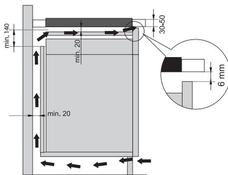
**РАЗМЕРЫ МОНТАЖНОГО ПРОЕМА (в зависимости от модели)**
