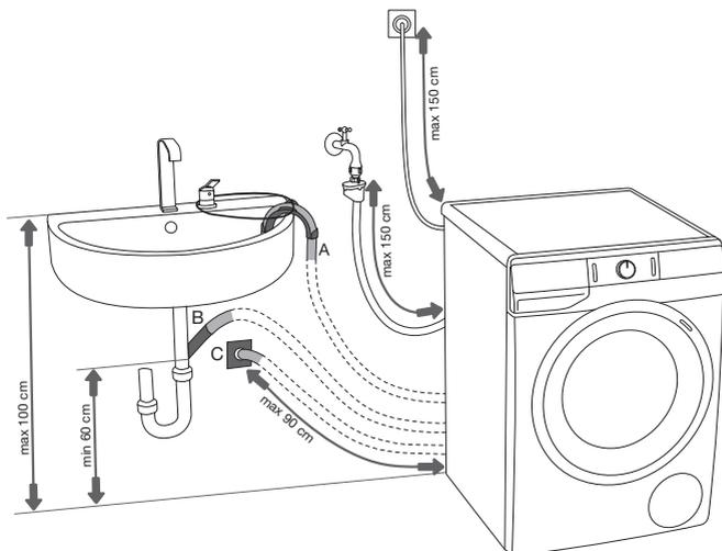
**А** Закрепите сливной шланг на раковине или ванне. Потяните шнур через пластмассовый кронштейн и закрепите сливной шланг так, чтобы он не соскальзывал на пол.
