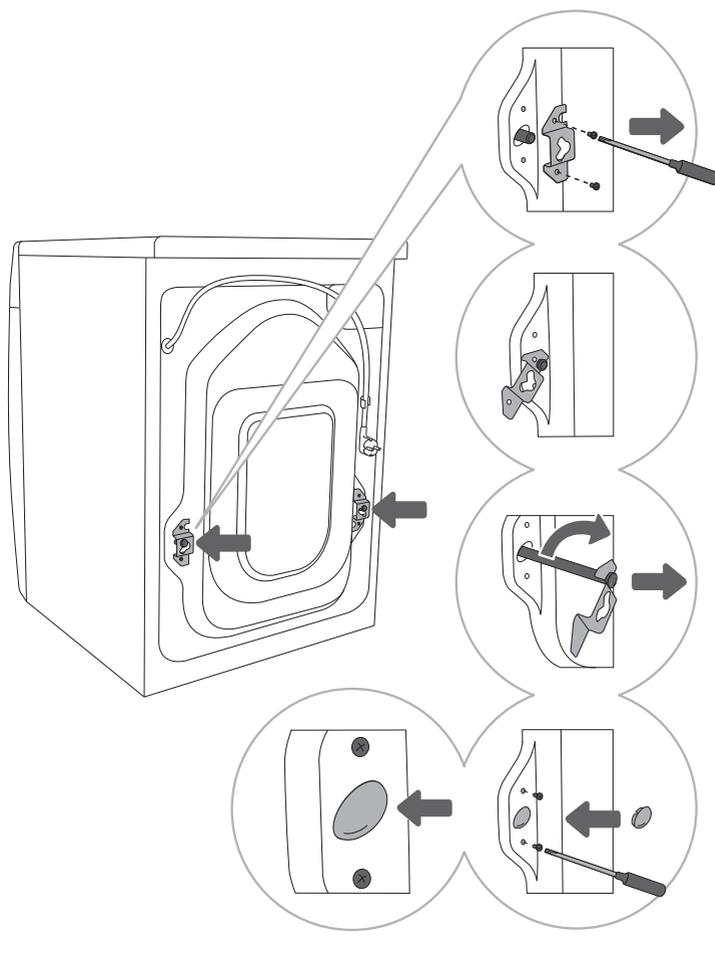
**1** Отодвиньте шланги и открутите винты на задней стенке стиральной машины. Снимите две крепежные скобы.
