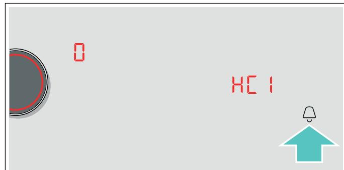
4. Установите съемным магнитным переключателем значение **1** «Соединить автоматически» или значение **2** «Соединить вручную».
