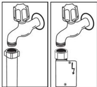
**ПРИМЕЧАНИЕ:** В некоторых моделях может применяться система защиты от протечек Aquastop. При наличии системы Aquastop возникает опасное напряжение. Не снимайте систему Aquastop. Она не должна сворачиваться или перекручиваться.
