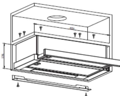
2. Для правильного монтажа проследите, чтобы вытяжка и навесной шкаф были вровень по задней стенке
