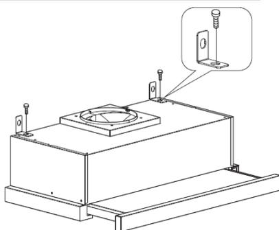
2. Установите L-образный кронштейн двумя винтами (4 мм x 10 мм)
