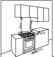
Распакуйте плиту, снимите липкую ленту и все упаковочные материалы и установите плиту на ровную поверхность. Плиту следует устанавливать непосредственно на пол.
