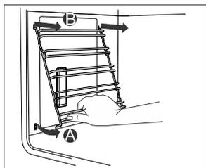
**A** Приподнимите направляющие снизу и отведите от стенки духовки.
