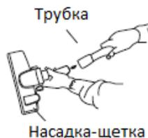
4. Установите на трубку подходящую насадку.
