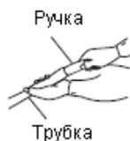
2. Соедините телескопическую трубку с ручкой гибкого шланга.
