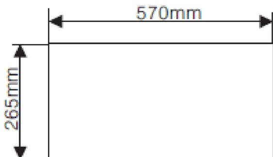
2. Просверлите отверстие в шкафу, с отверстием шириной 570x265 мм. Убедитесь, что край отверстия находится на расстоянии не менее 35 мм от края шкафа.
