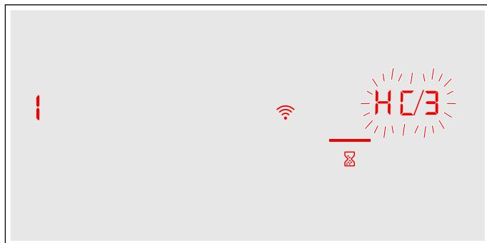
3. В зоне настройки установите значение **0**. Функция WLAN отключена и на панели управления гаснет символ
