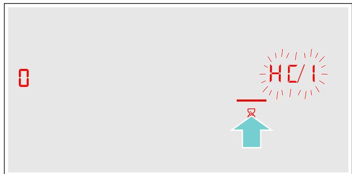
3. В зоне настройки Установите значение **1** «Соединить автоматически» или значение **2** «Соединить вручную».
