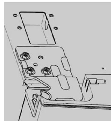
10. Снимите верхнюю левую крышку шарнира, подсоедините жгут проводов и установите его на шкаф.
