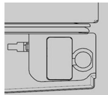
4. Снимите три болта с крышки петли на левой стороне верхней части прибора, снимите крышку петли, выньте жгут проводов из отверстия и установите втулку дверного вала.
