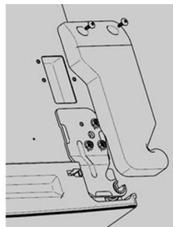
2. Отвинтите три болта на верхней петле, снимите верхнюю петлю и отодвиньте верхнюю крышку петли, дверную втулку, затем снимите шарнир, магнит.
