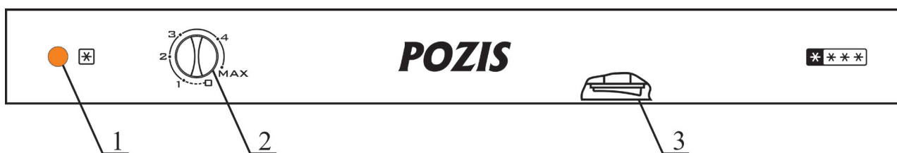
Рис.2 Схема расположения приборов управления и сигнализации 1 — индикаторная лампа; 2 — ручка терморегулятора; 3 — переключатель;
