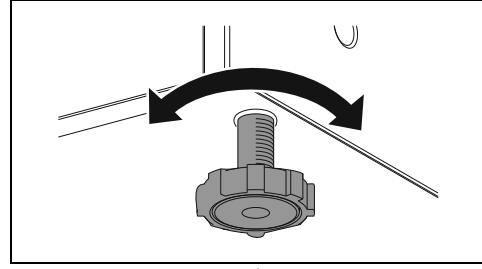
Для выравнивания прибора по горизонтали следует использовать эти ножки.
