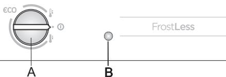
**A** Переключатель ВКЛ./ВЫКЛ. прибора, установки температуры, режима ЕСО и функции «Быстрое охлаждение и замораживание»
