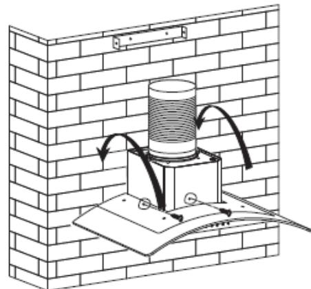
7. Поставьте декоративный короб на вытяжку и затяните, используй 2 шурупа (4мм x 8мм).
