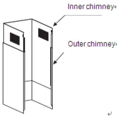
6. Повесьте вытяжку на шурупы в стене. Затем снимите алюминиевые фильтры и затяните места подвеса защелками.
