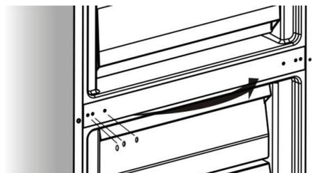
11. Наклоните холодильник назад, снимите деталь 2.
