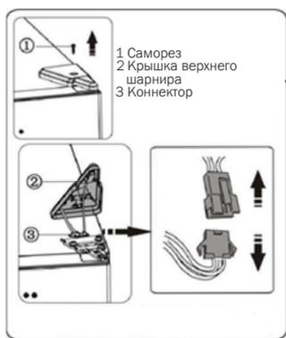
3. Открутите винты 1 и снимите шарнир 2. Извлеките провод коннектора 3 через отверстие шарнира 2. (Придерживайте верхнюю дверь рукой).
