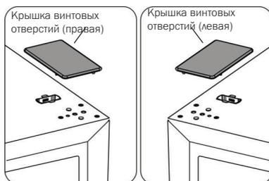
6. Снимите деталь 1 с левой стороны верхней крышки двери и выньте деталь 2. Снимите деталь 3 с правой стороны верхней крышки двери. Установите детали 3 и 4 с левой стороны верхней крышки двери. Установите деталь 1 с правой стороны верхней крышки двери.
