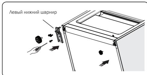
14. Установите нижнюю дверцу на стержень нижнего шарнира и придерживайте в этом положении. Переверните средний шарнир на 180°, переставьте шайбу на оси на нижнюю сторону, отрегулируйте положение шарнира и прикрутите так, чтобы нижняя дверца была надежно зафиксирована.
