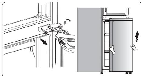
9. Положите дверь на мягкую поверхность лицевой панелью вверх. Открутите винт 3 и снимите детали 2 и 1. Установите прилагаемый левый ограничитель открывания двери 4 (в пакете) и деталь 2 (упор ограничителя) с левой стороны и закрепите с помощью винта 3. Сохраните деталь 1 для дальнейшего использования.
