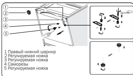
12. Снимите деталь 3 со стержня нижнего шарнира, затем открутите стержень нижнего шарнира, переставьте на другую сторону и прикрутите. Установите деталь 3 на стержень нижнего шарнира.
