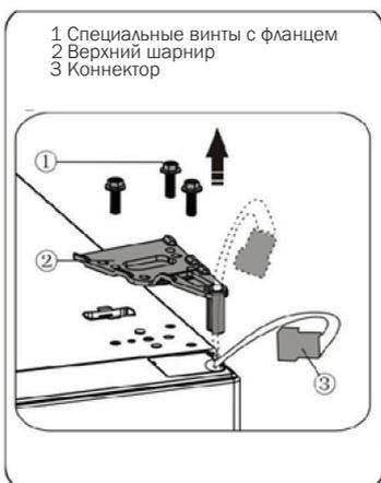
4. Приподнимите верхнюю дверцу и аккуратно снимите со среднего шарнира. Положите дверцу на мягкую поверхность, повернув лицевой панелью вверх.
