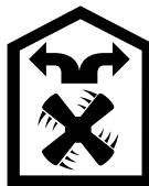
Васываемый воздух проходит через жироулавливающие фильтры и фильтр с активированным углём и очищенным выводится обратно в кухню.
