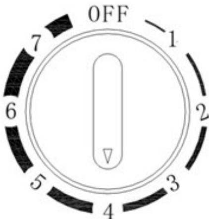
Отрегулировать температуру в холодильнике можно, с помощью терморегулятора, повернув ручку вправо или влево.
