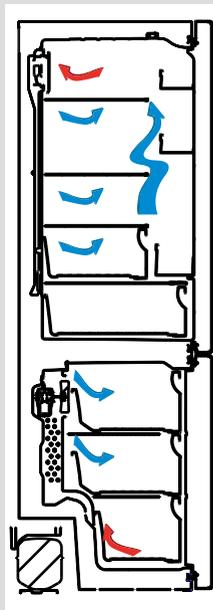
позади воздуховода. Одновременно воздух продувается через отверстия в воздуховоде, за счет чего осуществляется охлаждение в холодильном отделении. Конструкция отверстий в воздуховоде обеспечивает равномерное распределение воздуха в этом отделении.
