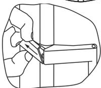
При замене (установке) ручки необходимо снять накладку (при открытой двери). Для этого нужно отогнуть один угол накладки как показано на рисунке и сдвинуть накладку по направлению стрелки.
