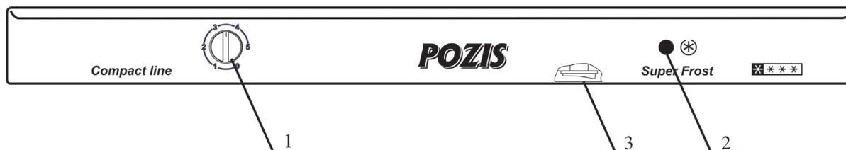
Рис.2 Схема расположения приборов управления и сигнализации
